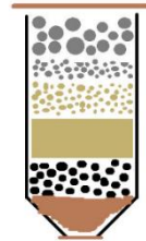
Εικόνα 1-2 : προσχέδιο φίλτρου #1 με σειρά εισαγωγής υλικών, διήθηση νερού φίλτρου #2
