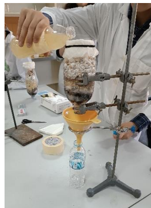
Εικόνα 3-4: προσχέδιο φίλτρου #2 με τη σειρά τοποθέτησης υλικών, διήθηση νερού φίλτρου #2
