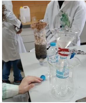
Εικόνα 1-2 : προσχέδιο φίλτρου #1 με σειρά εισαγωγής υλικών, διήθηση νερού φίλτρου #2
